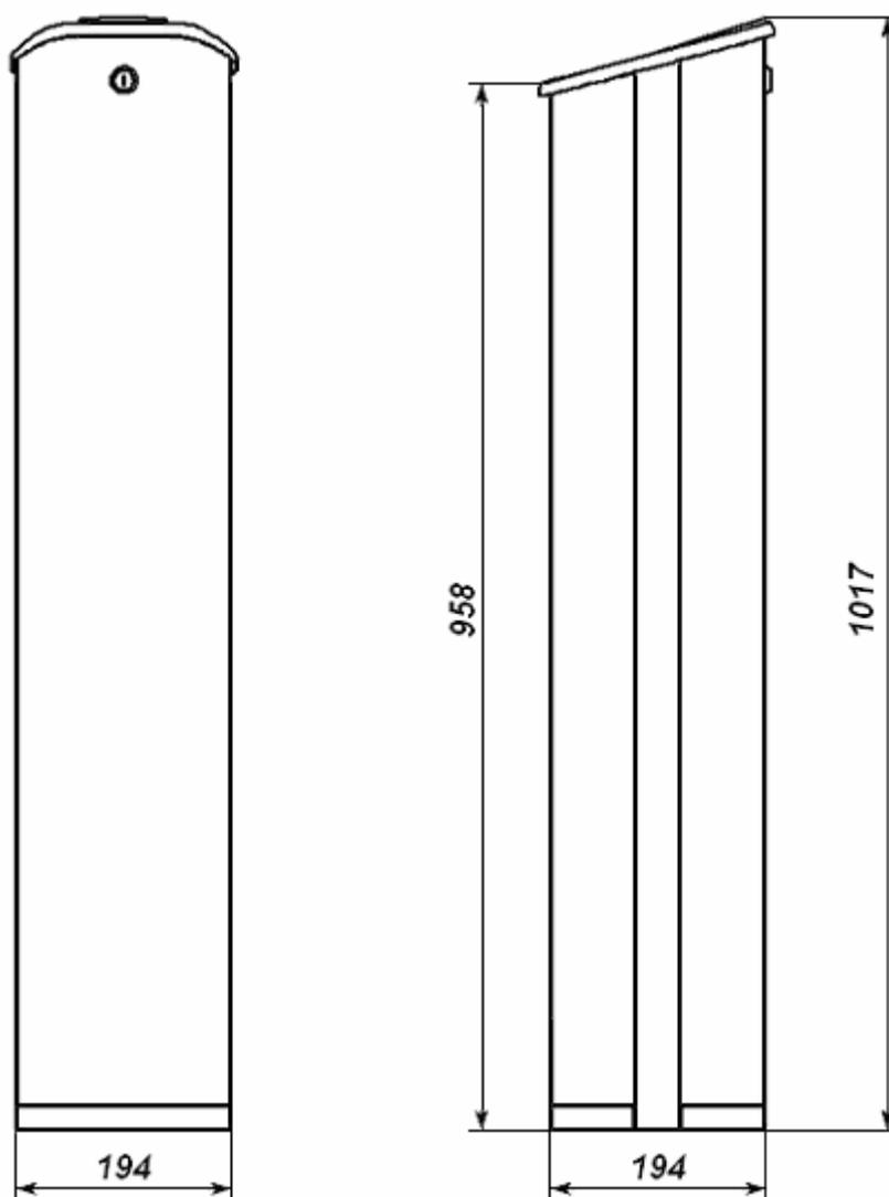
Рисунок 1 Габаритные размеры картоприемника
