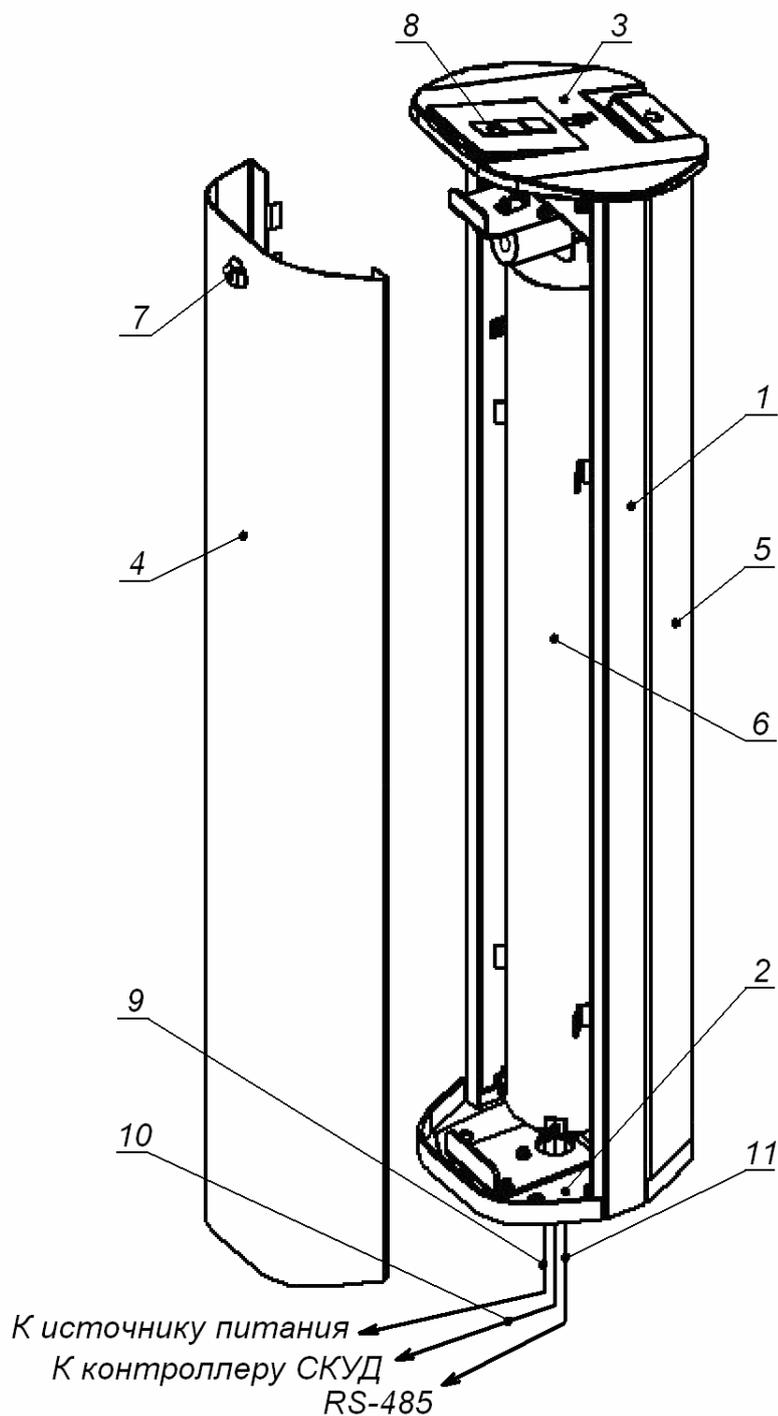
**Рисунок 2 Устройство картоприемника:**
