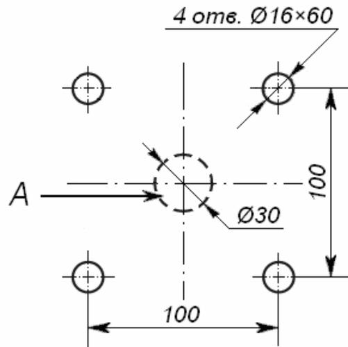
**Рисунок 5** Схема разметки для установки картоприемника:
