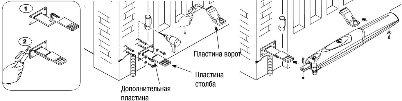
При установке привода 00.2AX5024 прикрепите пластину непосредственно к столбу без дополнительной пластины, соблюдая расстояния, приведенные в ТАБЛИЦЕ 2.
