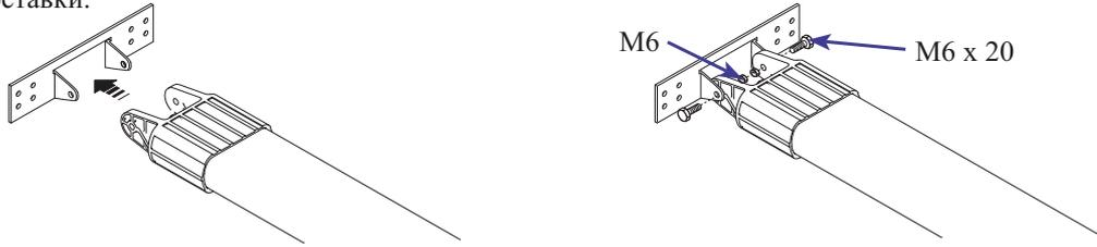
2) Закрепите направляющий профиль следующим образом:
