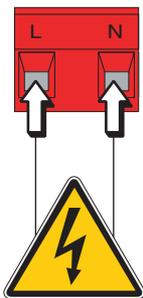
Вход для подключения электропитания ~220В, 50/60 Гц
