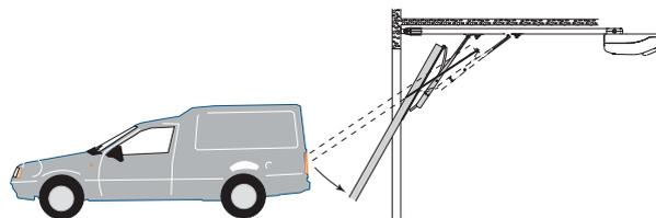
при закрывании: изменяет направление движения и полностью открывает ворота.
