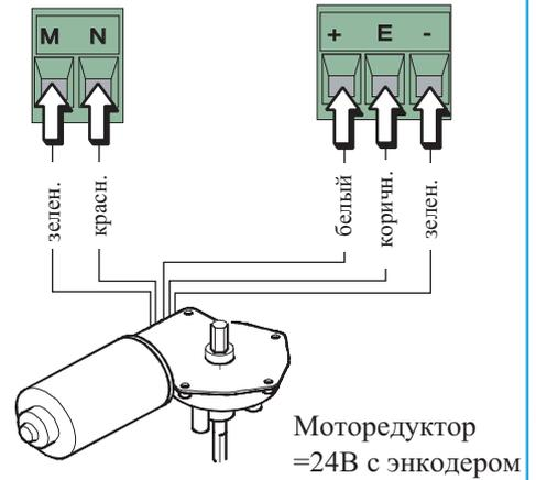
Моторедуктор =24В с энкодером
