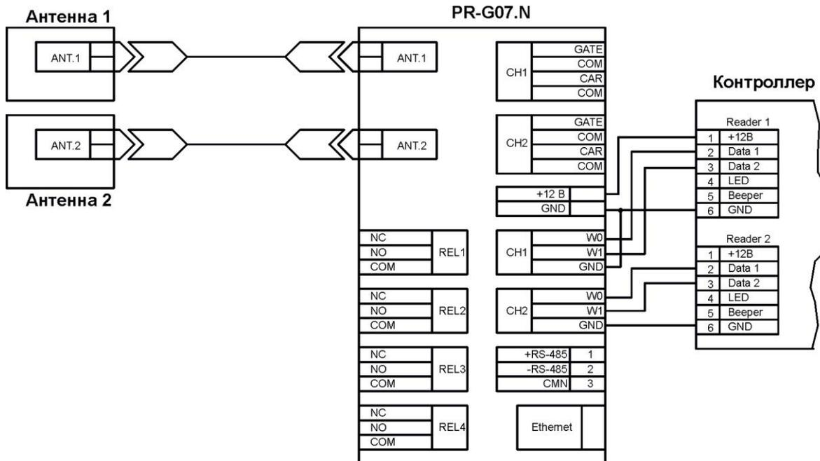
Рисунок 13. Интерфейс Wiegand
