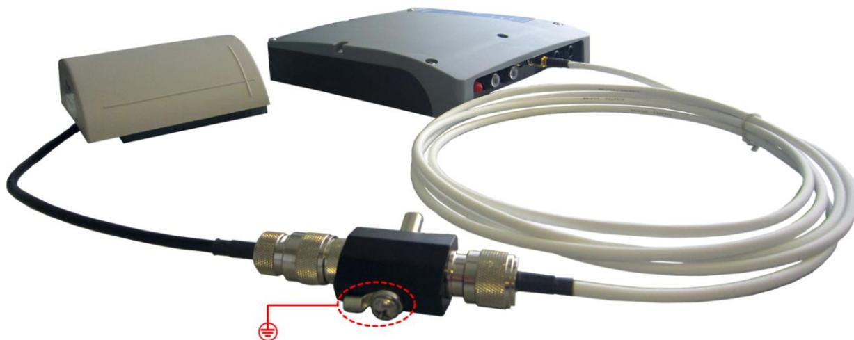
Рисунок 18. Установка грозоразрядника с комплектным кабелем
