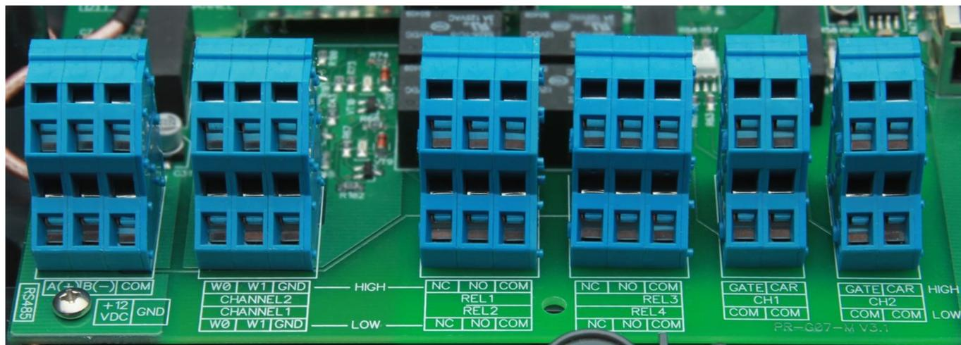
Рисунок 12. Узел клеммных колодок
