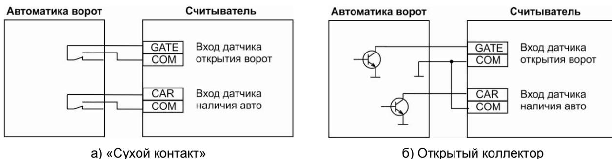
Рисунок 19. Подключение датчиков автоматики (один канал)
