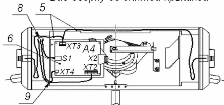
Рисунок 8 Схема прокладки кабелей в стойке ЭП
