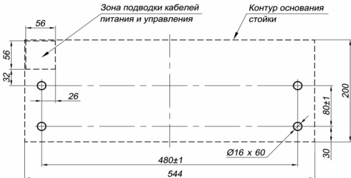
Рисунок 7 Схема разметки для установки стойки ЭП
