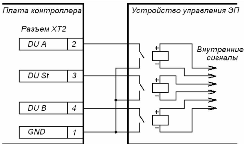
**Рисунок 4 Управляющие элементы устройства РУ:
