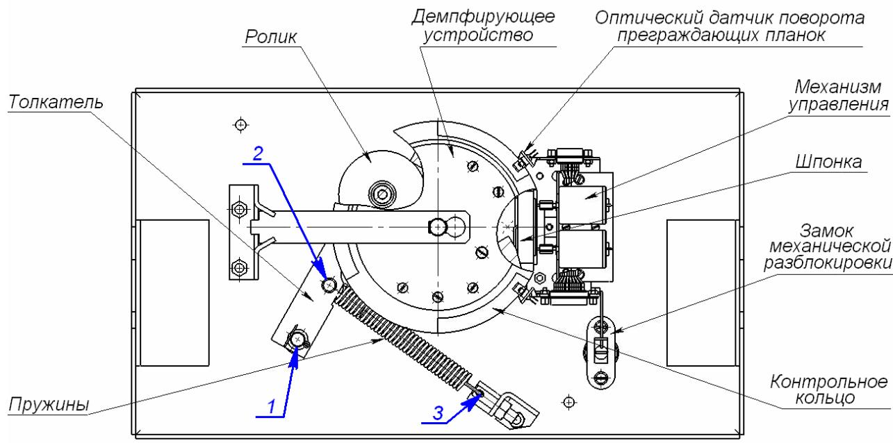
**Рисунок 10 Расположение внутренних деталей и узлов стойки ЭП**
