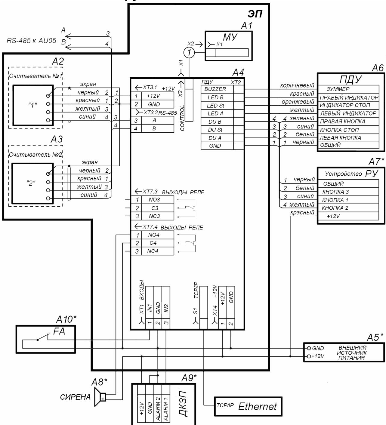
Рисунок 11. Схема подключения ЭП и дополнительного оборудования<sup>9</sup>
