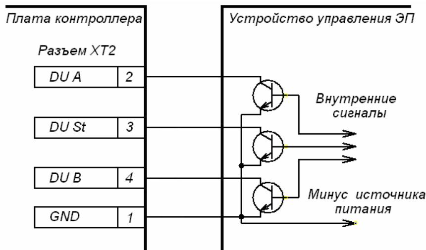
**Рисунок 5 Управляющие элементы устройства РУ:
