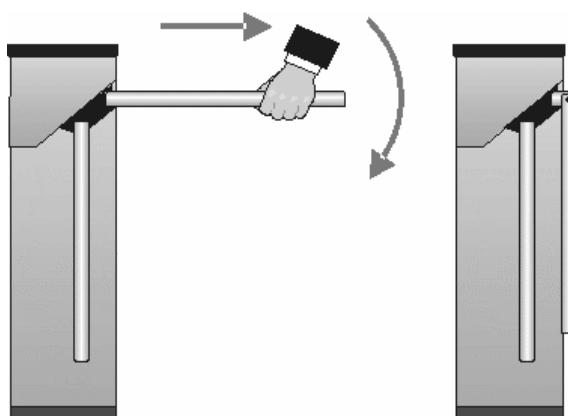
**Рисунок 9 Использование преграждающих планок Антипаника**
